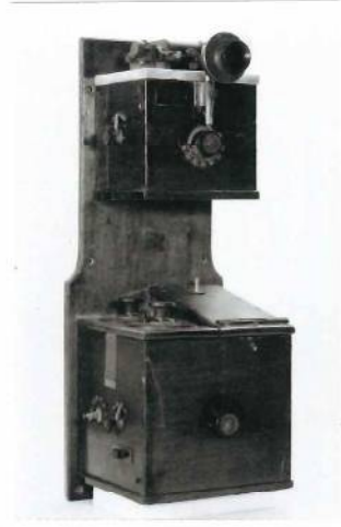
図12・5 鳥潟らのTYK 無線電話機 （世界初の無線電話の実用化）
