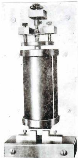
図 6・25 ターボ式水銀断続器実物の写真
