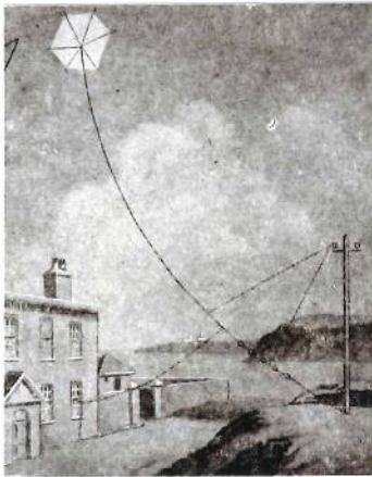
図4・12 凧による英・カナダ間大西洋横断無電実験 (明治34年だが結果に異論)
